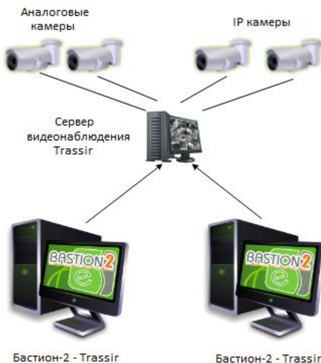
Рис. 1 – Схема работы драйвера «Бастион-2 – Trassir»
